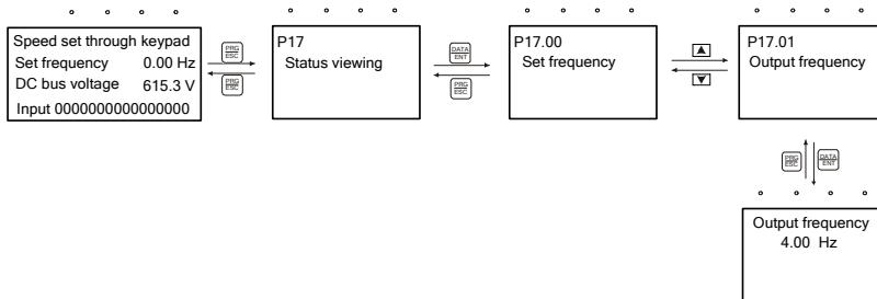
Figure 5-9 Viewing a parameter (LED)
